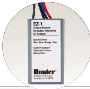
Hydrawise Software bietet jetzt mit dem Hunter EZ-Decodersystem eine einfache und kostengünstige Zweileiter-Decoderoption an. Betreiben Sie bis zu 54 Stationen über die Zweileiter-Technologie oder in Kombination mit herkömmlichen Ausgabe-Modulen.
